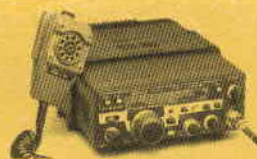
ICOM IC 290 E-D-H (IC290H 25 W) Ricetrasmittitore veicolare FM, SSB, CW, 144/148 MHz, potenza uscita RF 1/10 W, variabile, alimentazione 13,8 Vdc, passi da 100 Hz (SSB) - 5 kHz (FM), funzionamento automatico simplex, duplex + 600 kHz.
