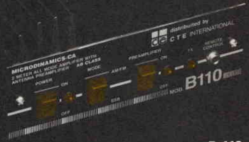
B 110 GASFET Booster completamente allo stato solido per i 2 metri. AM/FM/SSB 13,8 V - 110 W con preamplificatore d'antenna a gasfet
