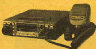
ICOM IC 27 E-H (IC27H 45 W) Ricetrasmittitore VHF veicolare, per emissioni FM, 144/146 MHz, 9 memorie, 32 frequenze sub audio, potenza RF 25 W, alimentazione 13,8 Vdc.
