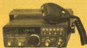
YAESU FT 780 R Ricetrasmittitore UHF 430/440 MHz: 400 canali con memorie, potenza uscita RF 15 W PeP, emissione FM, LSB, USB, CW, alimentazione 13,8 Vdc, scansione automatica, sull'apparato e microfono.
